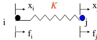
$$\begin{cases} K(x_i - x_j) = f_i \\ -K(x_i - x_j) = f_j \end{cases} \rightarrow \begin{bmatrix} k_{ii} & k_{ij} \\ k_{ji} & k_{jj} \end{bmatrix} \begin{bmatrix} x_i \\ x_j \end{bmatrix} = \begin{bmatrix} f_i \\ f_j \end{bmatrix}$$
